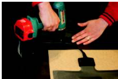
Befestigen der Schäume
